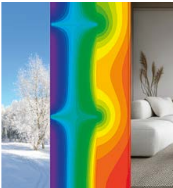
Abbildung 1 Ausgeprägte Wärmebrücke bei Aluminiumkonsolen
