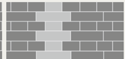
Blockverband Läufer und Köpfe wechseln regelmäßig ab. Die Stoßfugen der jeweiligen Schichten liegen senkrecht übereinander.
