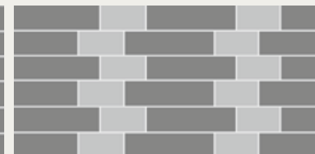
Gotischer Verband Läufer und Köpfe wechseln innerhalb einer Schicht regelmäßig ab. Die Stoßfugen jeder zweiten Schicht liegen übereinander; dazwischen sind sie jeweils um \frac{1}{2} Kopfbreite versetzt.
