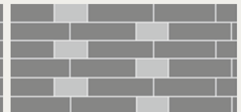
Märkischer Verband Je zwei Läufer und ein Kopf wechseln Schicht für Schicht regelmäßig ab, wobei die Stoßfugen jeder zweiten Schicht übereinander liegen.
